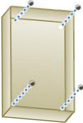
本製品の筐体をボルト(M10 推奨)で 4 カ所を固定し、取り付けてください。
