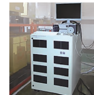
充放電試験装置
